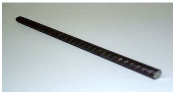
Barra de aço de construção de 8 mm de diâmetro
